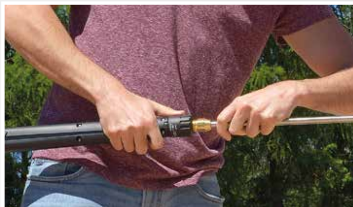
Rys. Wykonanie ze złączem gwintowym
